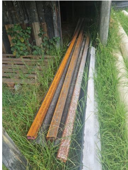
Perfiles metálicos oxidados
